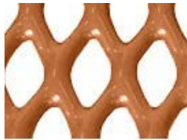
Figure 6.4 Photo d'un exemple de plancher métallique enduit de vinyle utilisé dans l'étude de Wilson et coll. (1998)
