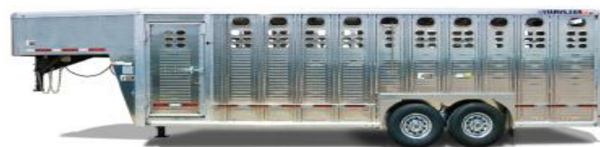
Figure 3 : Remorque à bestiaux à col de cygne à essieux tandem (pour camionnette) (source : Wilson Trailer Company)
